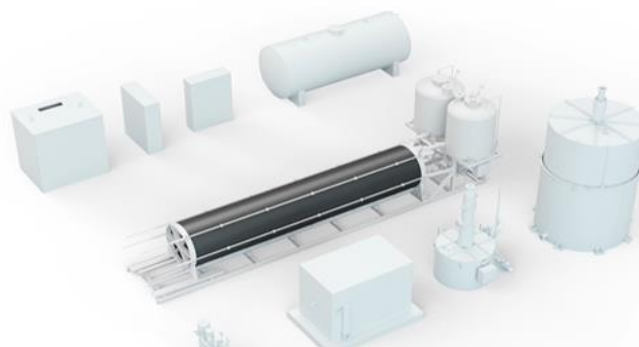
Figura 4.2: Modelo esquemático da planta de produção de hidrogênio.
